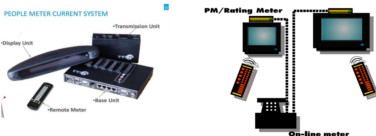
ภาพที่ 9 เครื่อง People Meter ที่ใช้ในการสำรวจเรตติ้งโทรทัศน์
